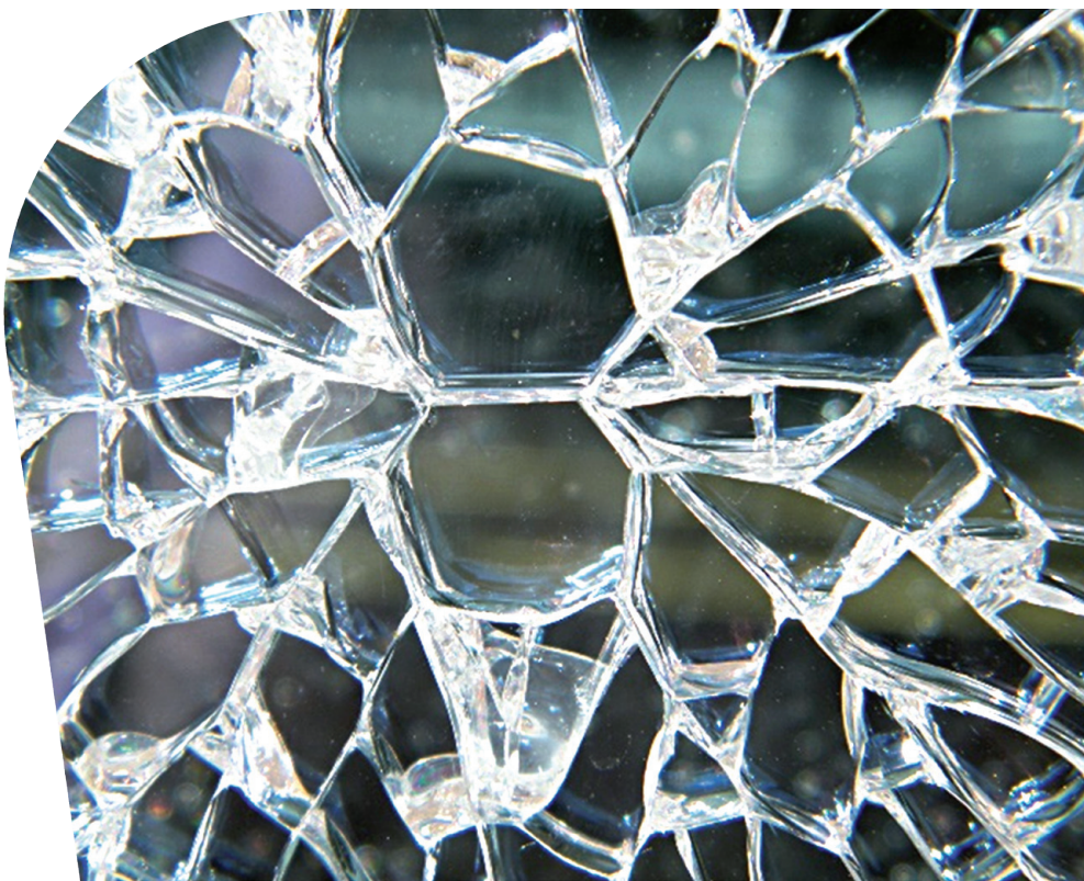
Výkres 10. Pohled na strukturu prasknutí kaleného skla, ve které mohlo dojít k samovolnému rozbití v důsledku vlivu NiS.
